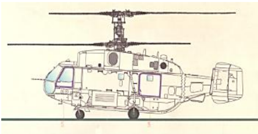
Рис. 2. Основные габаритные характеристики вертолета КА-32 и МИ-8Т: входная левая дверь: 1 200х1 200 мм, есть модификации с двумя дверьми по обоим бортам; высота салона: 1 320 мм; пол грузовой кабины: ширина 1 300 мм, длина 4 520 мм; количество посадочных мест в транспортном варианте: 16; применяемые лебедки – ЛПГ-300 (аналог СЛГ-300) находится снаружи фюзеляжа
